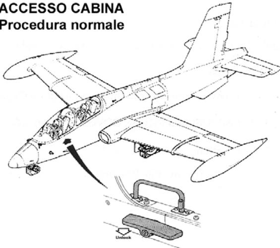
1. Ruotare la maniglia di sblocco del tettuccio in senso antiorario;
