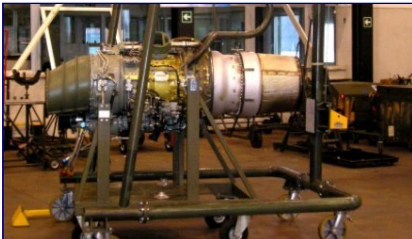
**Vista laterale del motore Rolls Royce Fiat 632-43 Viper allestito e completo di accessori posizionato sullo stand di manutenzione**
