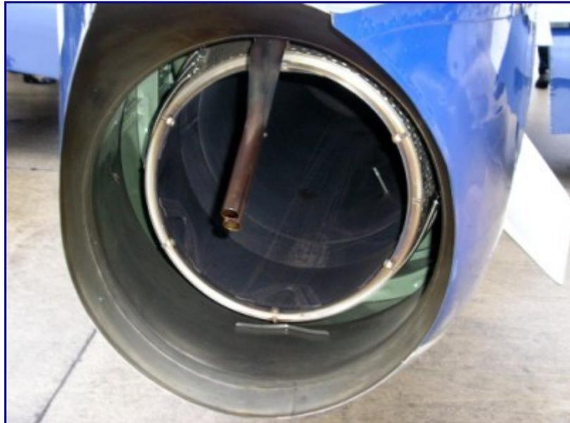
**Vista della parte posteriore del poppino di un MB339PAN: sono visibili in primo piano le due tubazioni dell'impianto fumogeno e in secondo piano il tubo di scarico del getto. Sono visibili anche le termocoppie del sistema EGT e le sedi dei trimmers di calibrazione della spinta.**
