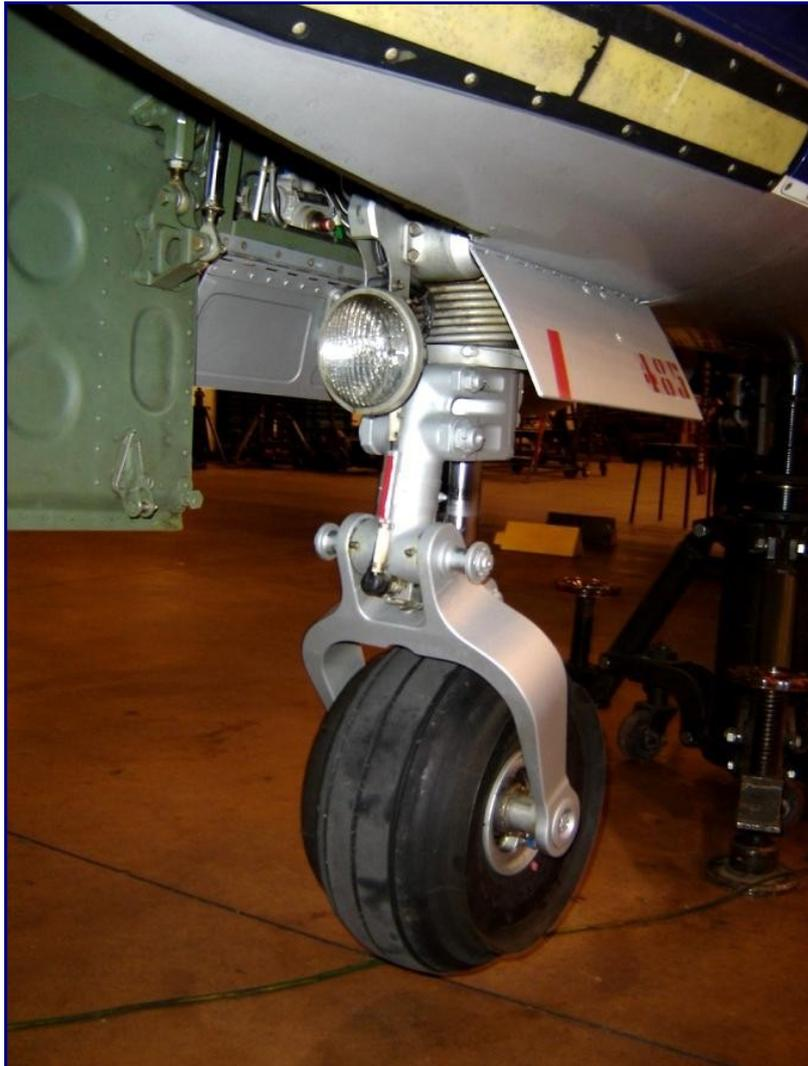
**Dettaglio del carrello anteriore in condizione estesa. Notare il porello del vano nella condizione di transito**
