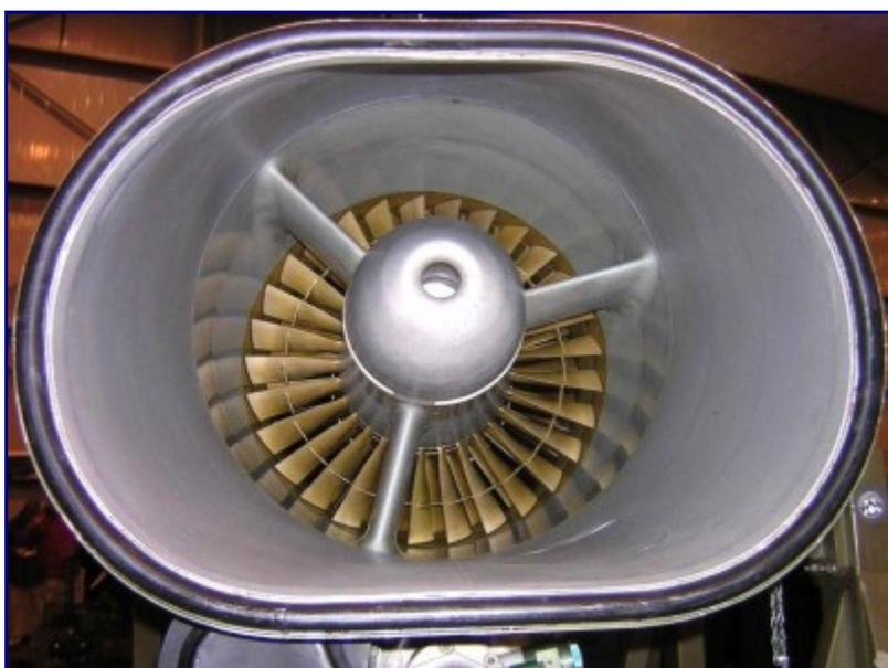
**Vista del condotto principale di adduzione dell'aria, la palettatura del primo stadio del compressore assiale e l'alloggiamento del cuscinetto anteriore. Il colore giallo delle palette del compressore è dato dal trattamento anticorrosivo Sermetel**
