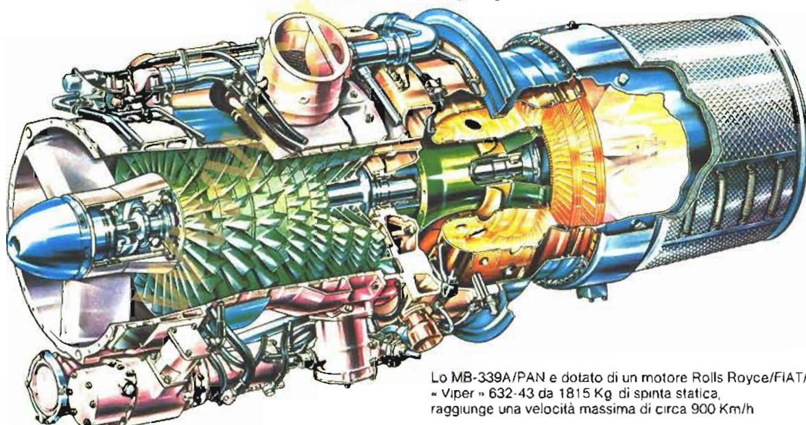
Lo MB-339A/PAN è dotato di un motore Rolls Royce/FIAT/Piaggio/R.R. « Viper » 632-43 da 1815 Kg di spinta statica, raggiunge una velocità massima di circa 900 Km/h
